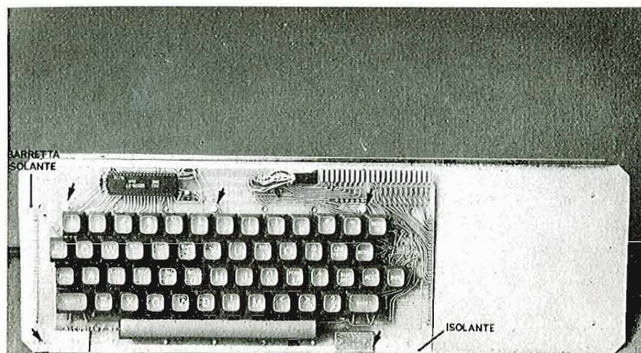
Fig. 7 - In questa fotografia si mostra la giusta allocazione del circuito stampato della tastiera sulla parte metallica della carrozzeria. Le frecce stanno ad indicare i punti dove occorre fare particolare attenzione.
