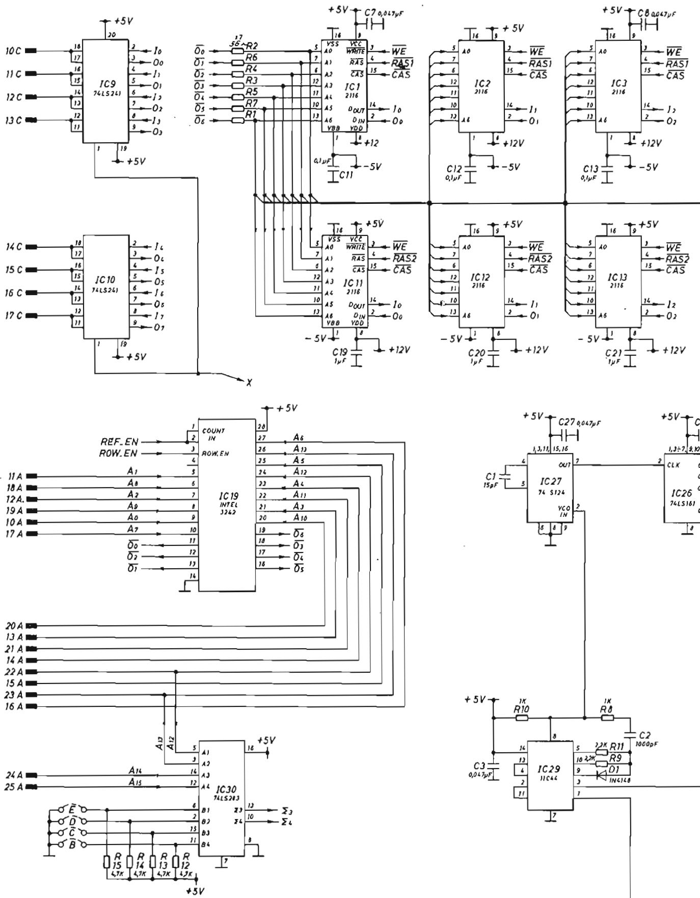
Fig. 2 - Schema elettrico della RAM dinamica da 32K byte mod. A2000/18-32.
