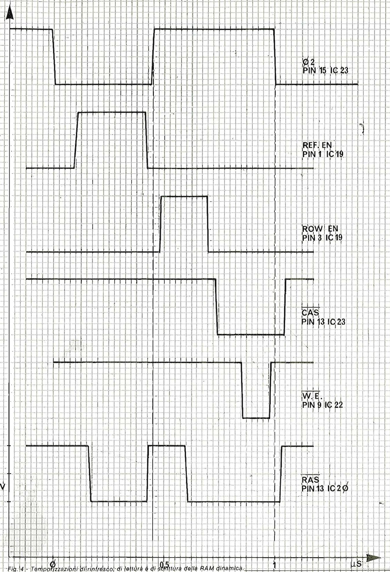
Fig. 4 - Temporizzazioni di rinfresco, di lettura e di scrittura della RAM dinamica.
