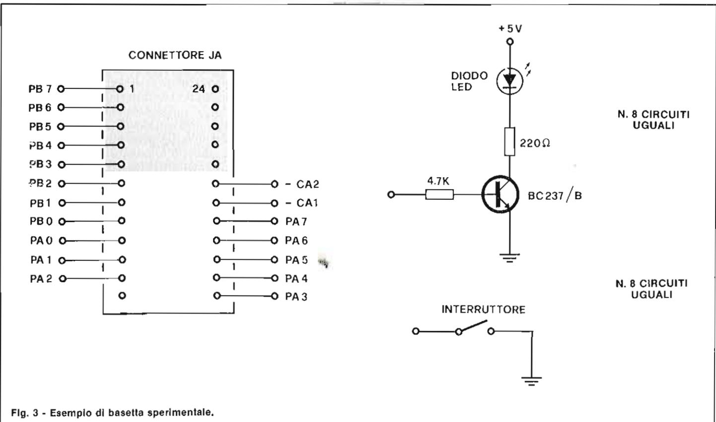
Fig. 3 - Esempio di basetta sperimentale.
