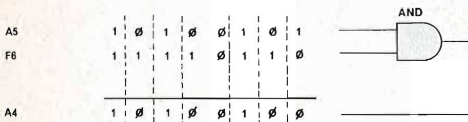
Fig. 5 - Come il microelaboratore esegue l'operazione A.
